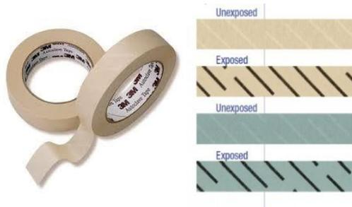
Gambar V.18 Perubahan Warna Pada Indikator Kimia Sebelum dan Setelah Proses Autoklaf
